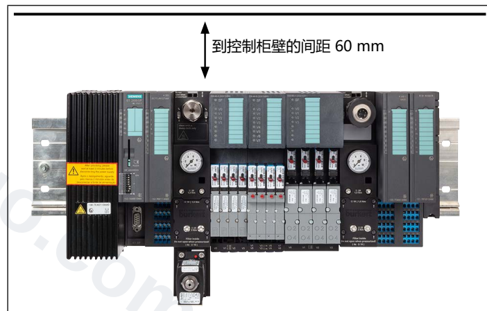
图26: 顶部到控制柜壁的间距
