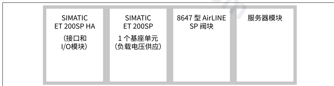
图12: SIMATIC ET 200SP HA 与 8647 型 AirLINE SP 的站点布局示意图
