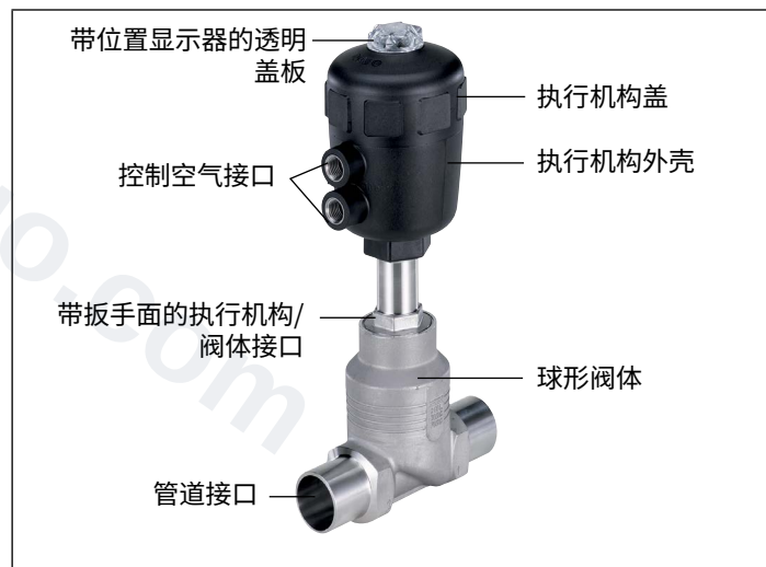
图1: 2012 型直座阀, 结构和说明
