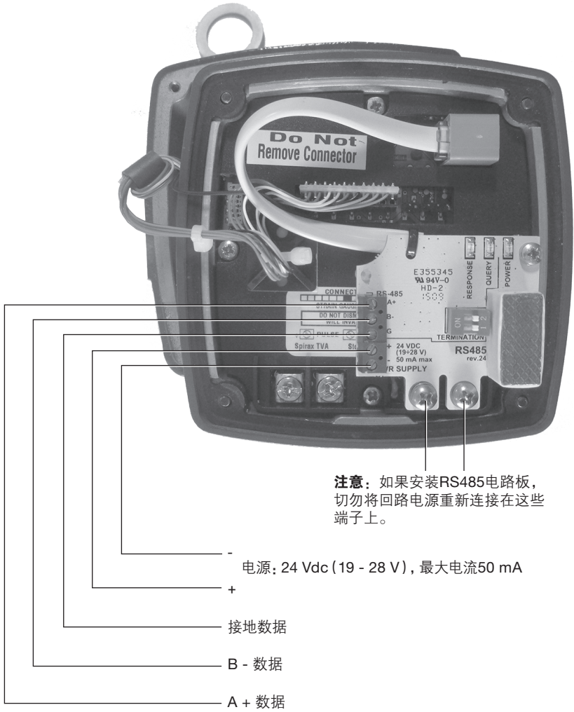
图21 TVA 带EIA 485 (RS 485)通讯接线图
